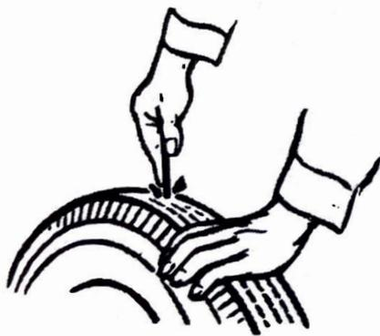
Fremdkörper, die in den Reifen eingedrungen sind, erst unmittelbar vor der Reparatur entfernen.
