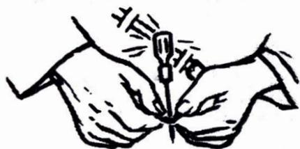
Für das Aufpumpen ist es meist nötig, den Reifen an seinem Umfang zusammenzudrücken, damit die Wülste gegen die Felge gedrückt werden. Anstelle des Spezialwerkzeugs kann ein Seil verwendet werden, das durch Zusammendrehen mit einem Metallstab gespannt wird. Zug beim Aufpumpen langsam nachlassen, die Wülste gleiten dann von selbst in die Sicherheitsnuten.
