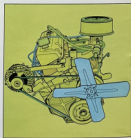
Der nur in USA-Modellen lieferbare Standard-Benzinmotor hat 2,8 Liter Inhalt. Er ist um 30° geneigt montiert. Dadurch wird die Motorhöhe niedriger und die Sicht noch besser.
