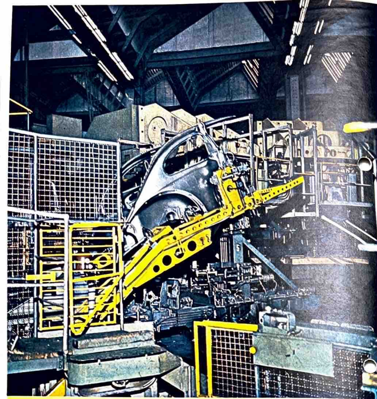
Tausende Male hebt dieser gelbe Doppelarm die hinteren Seitenteile einer Karosserie in ein Karussell, wo sie zum Hinterwagen zusammengeschweisst werden.
