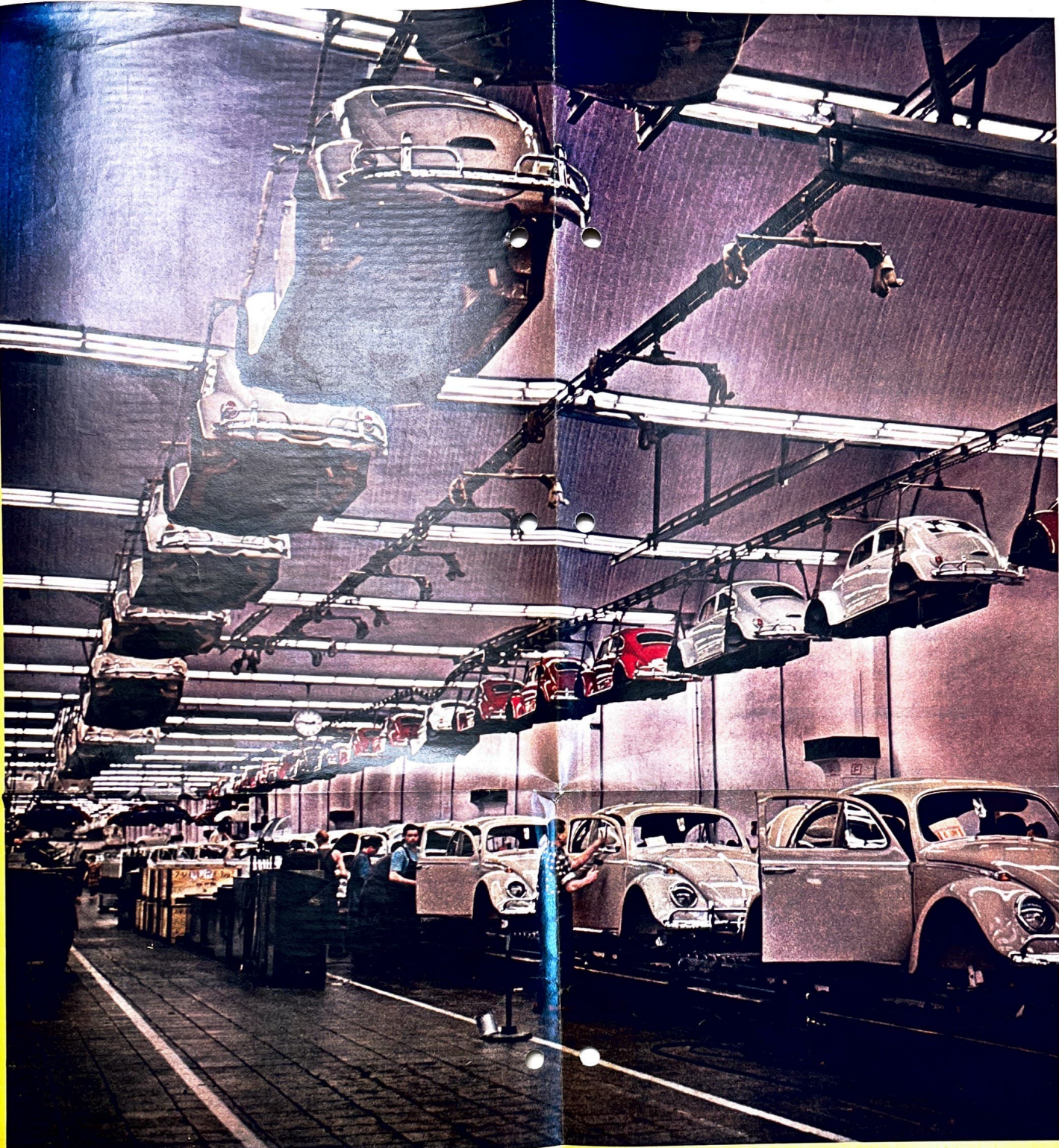
Frisch lackiert schweben die neuen Karosserien in leisen Schaukelbewegungen durch die Hallen, wo sie auf die Chassis aufgesetzt werden, um alsbald aus eigener Kraft zu den Kontrollen zu fahren.
