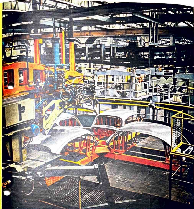
Orangerote Greifer setzen das Dach des Automobils auf, pressen es auf, während automatische Schweißvorrichtungen das metallene Dach befestigen.
