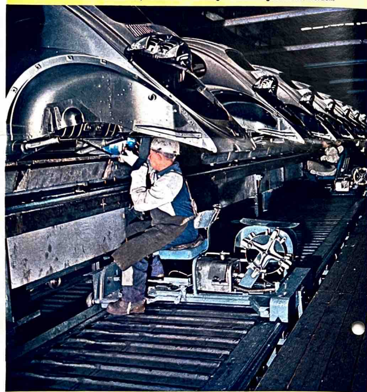
Nicht jede Arbeit kann automatisch ausgeführt werden. Schwer zugängliche Stellen werden von Schweißern besonders bearbeitet. Die Schweißer fahren mit dem Fließband mit.
